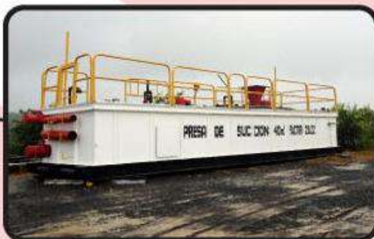
Recubrimiento anticorrosivo y reforzamiento con fibra de carbono Anticorrosive coating and carbon fiber reinforcement PEMEX, Comalcalco, Tabasco.
